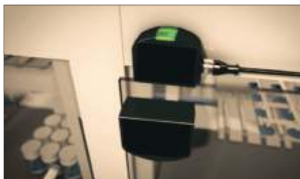
Figura 11: Interblocco RFID tipo 4 a codifica alta
