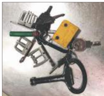
Figura 4: Kit di azionatori frequentemente utilizzato per manomettere gli interblocchi di sicurezza dotati di basso livello di codifica
