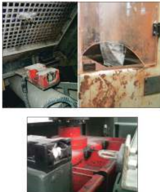
Figura 10: rottura accidentale: interblocco a chiavetta danneggiato a causa di ripetuti urti per disallineamento dell'attuatore con il sistema di azionamento
