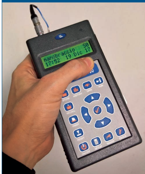
Figura 40 Esempio di vibrometro portatile
