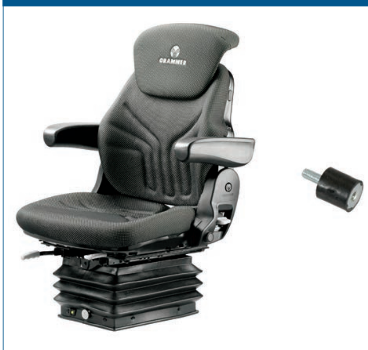
Figura 14 Sedile ammortizzato e Silent Block
