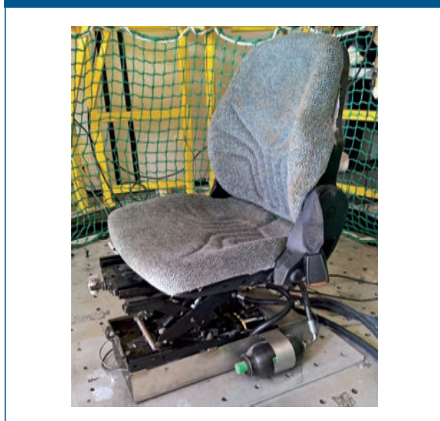
Figura 23 Prototipo di sedile a controllo attivo Inail
