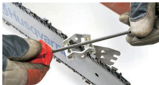
Figura 24 Esempio di affilatura della catena
